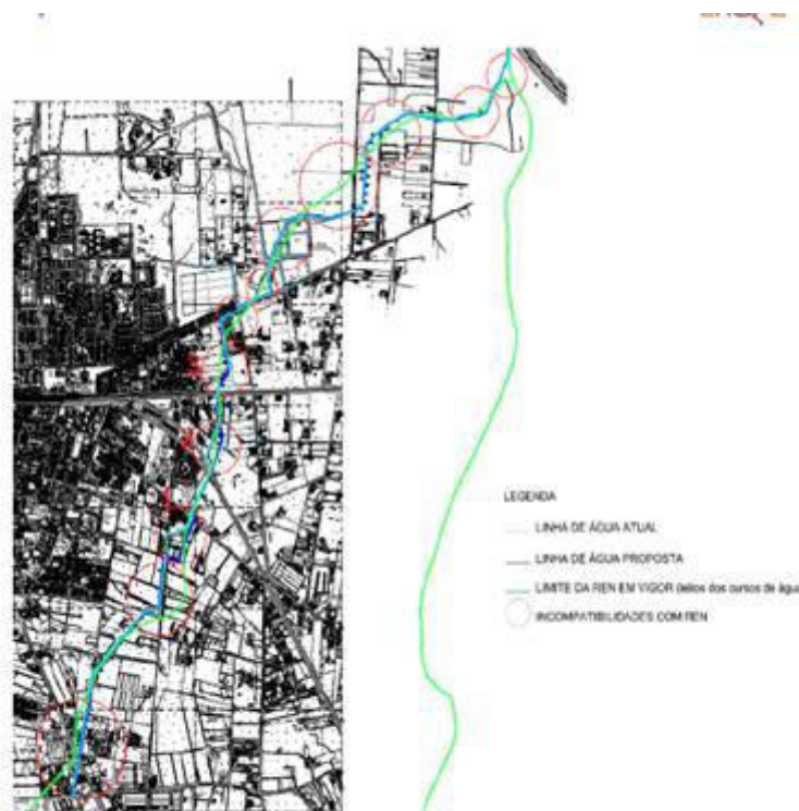
Figura 4-66 – Representação da linha de água cartografada na REN, linha de água existente e desvios propostos no projeto (excerto da peça desenhada D05.Rev01)
